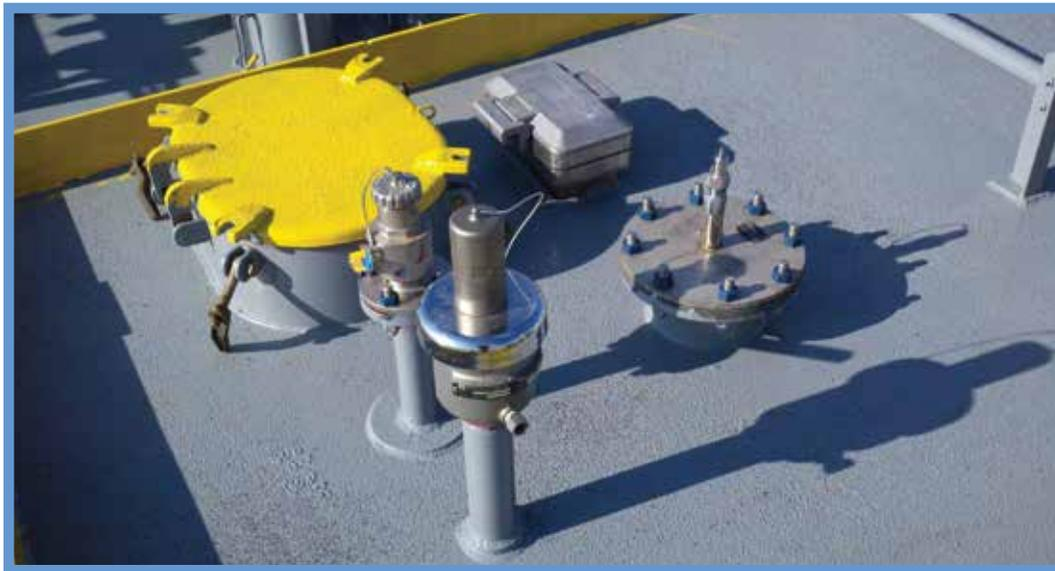
Medidor de vara ascendente de un metro DS-39™, válvula de esfera de muestra, válvula piloto Equate de 2.5" y visor de vista completa SGM-1.
