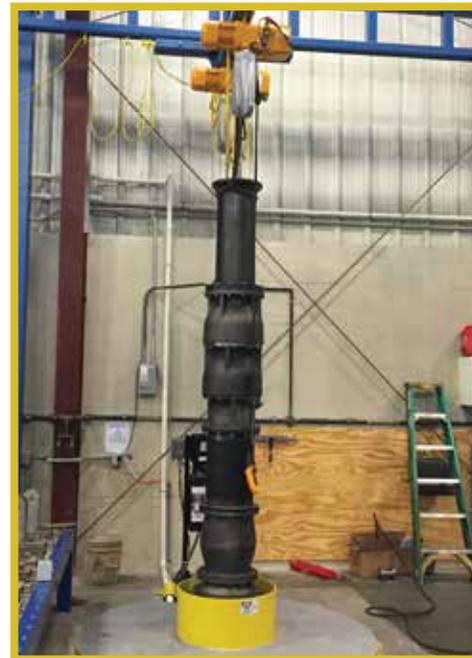
Todos los componentes de las bombas de barcaza 10LS y 12LS de ERL están mecanizados y ensamblados en una planta de New Albany, Indiana. Las piezas moldeadas proceden de nuestros proveedores locales, se producen a partir de nuestros modelos informáticos y se fabrican utilizando nuestras propias herramientas. ERL ha construido estaciones de montaje altamente funcionales, completas con una fosa de elevador hidráulico para permitir que los componentes se ensamblen verticalmente.
