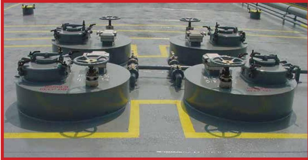
Visores SGM-1™ modelo de vista completa - cubiertas cerradas - montados sobre domos de expansión.
