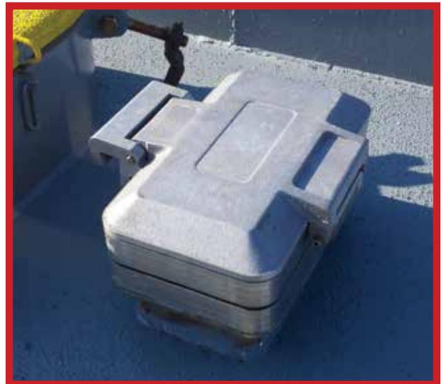
Visor SGM-1™ MODELO DE VISTA COMPLETA - cubierta cerrada - montado sobre domo de expansión.
